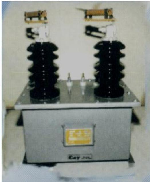
Es un transformador devanado especialmente, con un primario de alto voltaje y un secundario de baja tensión. Tiene una potencia nominal muy baja y su único objetivo es suministrar una muestra de voltaje del sistema de potencia, para que se mida con instrumentos incorporados.
